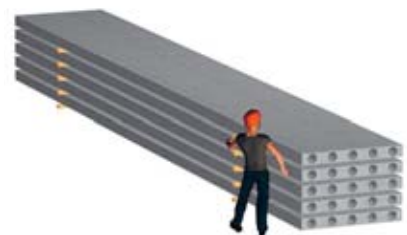
3 Cautela in presenza di appoggi temporanei: evitare il ribaltamento di travi!
