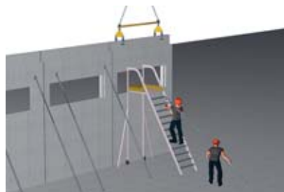
2 Montaggio di puntelli.
