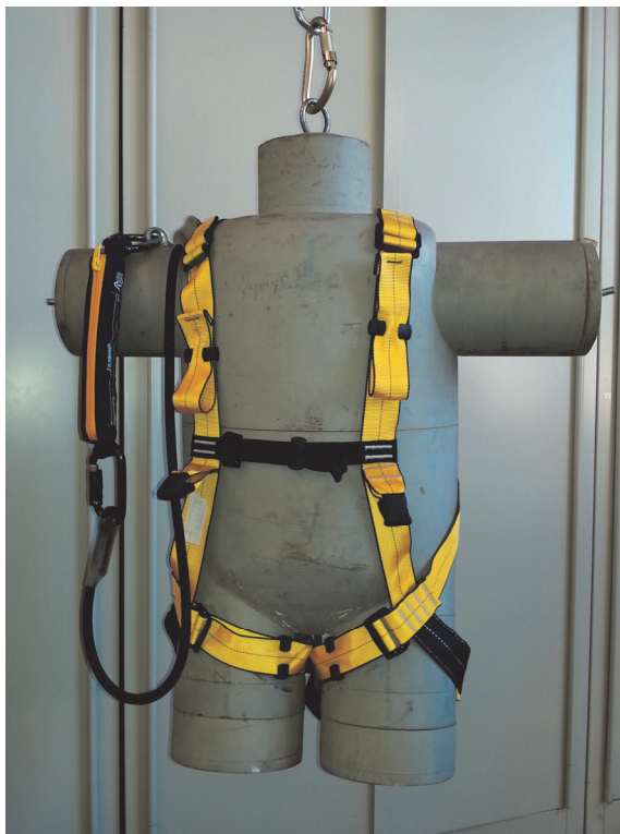
Figura 4.2.2.2-5 Torso strumentato con sistema di arresto caduta F
