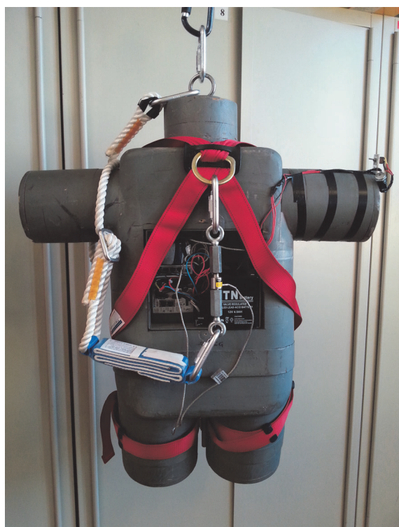
Figura 4.2.1-2 Vista posteriore del torso di prova
