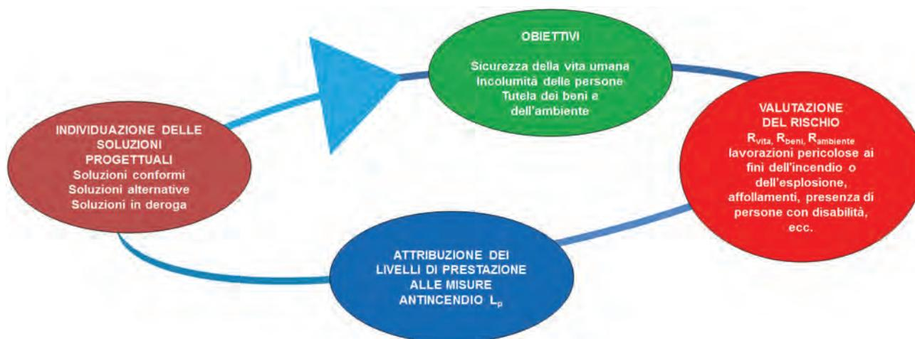
FIG. 11 LA PROGETTAZIONE ANTINCENDIO SECONDO IL CODICE
